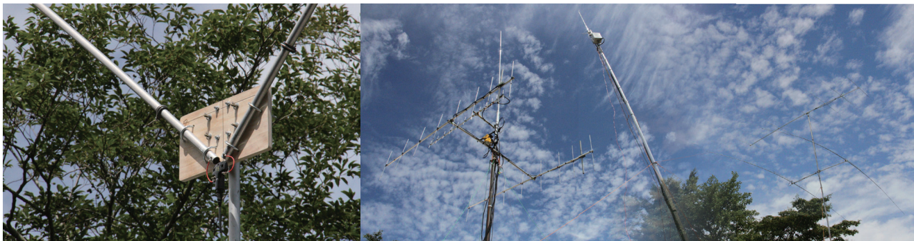
左：V型ダイポールマウント部（現地で自作）、中央：144MHz スタック 430MHz 1200MHz Yagi, 2.4G 5.6G GP, 右：14MHz Zele HB9CV, 50MHz 6ele Yagi
