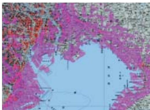
図：電波の見通しマップ (カシミール 3D にて計算) 【条件】 標高：海拔 +10m, 地球半径の倍数：1.33
